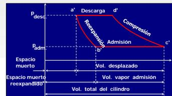
$$R_v = \frac{\text{(volumen de admisión)}}{\text{(volumen desplazado)}} = \frac{V_{c'} - V_{b'}}{V_{c'} - V_{a'}} = \frac{(V_{c'} - V_{a'}) - (V_{b'} - V_{a'})}{V_{c'} - V_{a'}} = 1 + \frac{V_{a'} - V_{b'}}{V_{c'} - V_{a'}}$$
