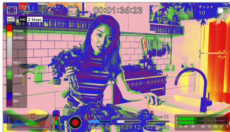
適切に露出されたイメージでは、スキントーンは緑とピンクのフォスカラーで表示
