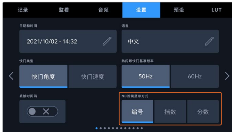
URSA Broadcast G2机型的设置菜单会提供选项来自定义ND滤镜信息的显示方式。
