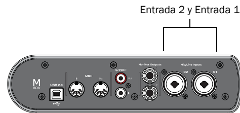
Entradas en el panel posterior de Mbox
