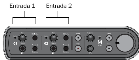
Entradas en el panel frontal de Mbox
